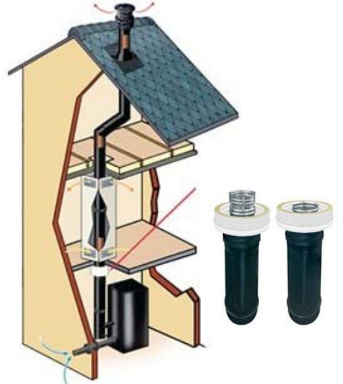
Figure 4.4 - Départ plafond (tubage flexible d'un conduit métallique existant avec kit de rénovation concentrique)
