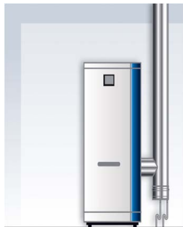
Figure 12 : Purge pour l'évacuation des condensats
