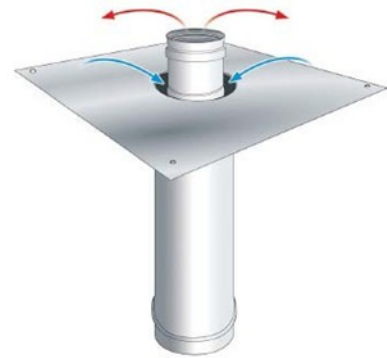
Figure 5.4 – kit de rénovation concentrique pour conduit maçonné avec tubage rigide
