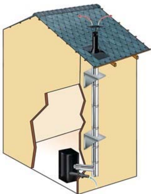
Figure 3.2 – Situation extérieure (avec prise d'air indépendante)
