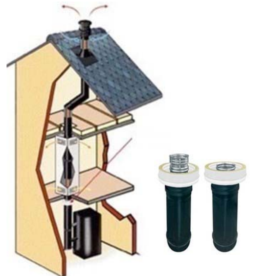
Figure 2.6 – Départ Plafond (tubage flexible d'un conduit métallique existant avec kit de rénovation concentrique)
